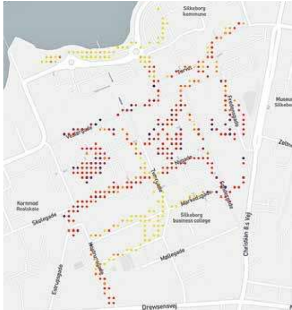
Figur 5: 745 målinger giver et overblik over netværkskvalitet i Silkeborg midtby. Gule prikker er der, hvor dækningen er bedst.
