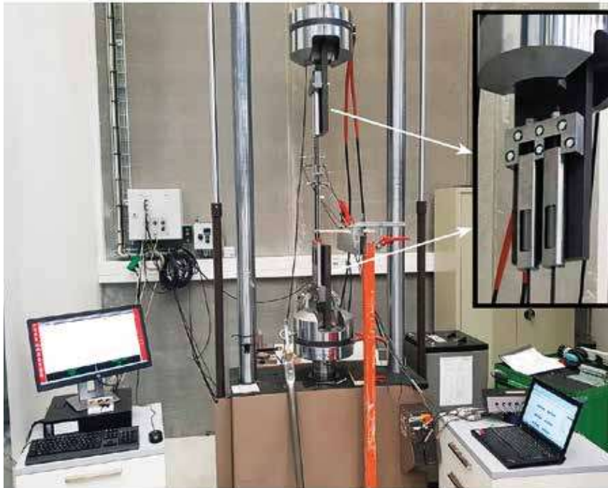
Figur 4: Opspænding af det nye kulfiberforstærkningsystem i Aalborg Universitets laboratorium
