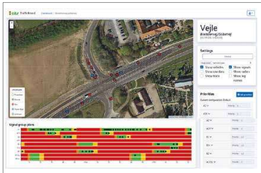
Figur 1: Overblikket i TrafficBoard for Bredstenvej/Skibetvej. Via et ortofoto kan de forskellige køretøjer i krydset observeres i realtid. Systemet viser under dette live signalgruppeafvikling. Til højre nederst ses prioriteringen. I dette tilfælde er B-retningen vægtes 50 % højere end de andre retninger.
