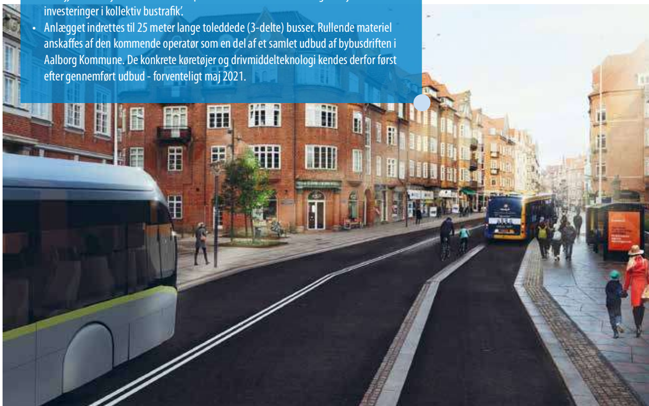
Figur 2: Boulevarden sideudvides som vist på denne visualisering (COWI) for at sikre bedre plads til BRT-busserne. Men gadens funktion som handels- og cafégade er styrende for indpasningen af BRT-systemet. Buslommen til højre er til bybusser og benyttes ikke af Plusbusserne.
