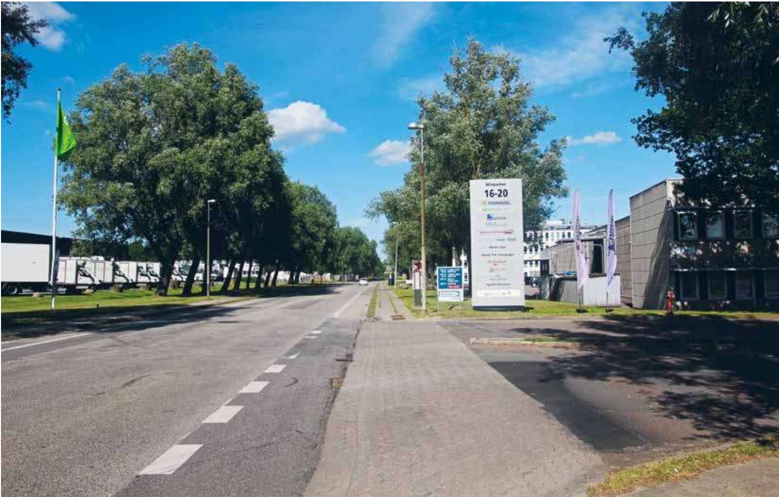
Midtager, Brøndby Kommune. Den brede overkørsel er nødvendig af hensyn til tunge køretøjers arealbehov. Hvis trafikken til/fra en ejendom ændrer sig markant i forbindelse med en ny afvigende funktion, bør store og brede overkørsler ombygges, så de bliver mindre og mere overskuelige. Foto: Via Trafik
